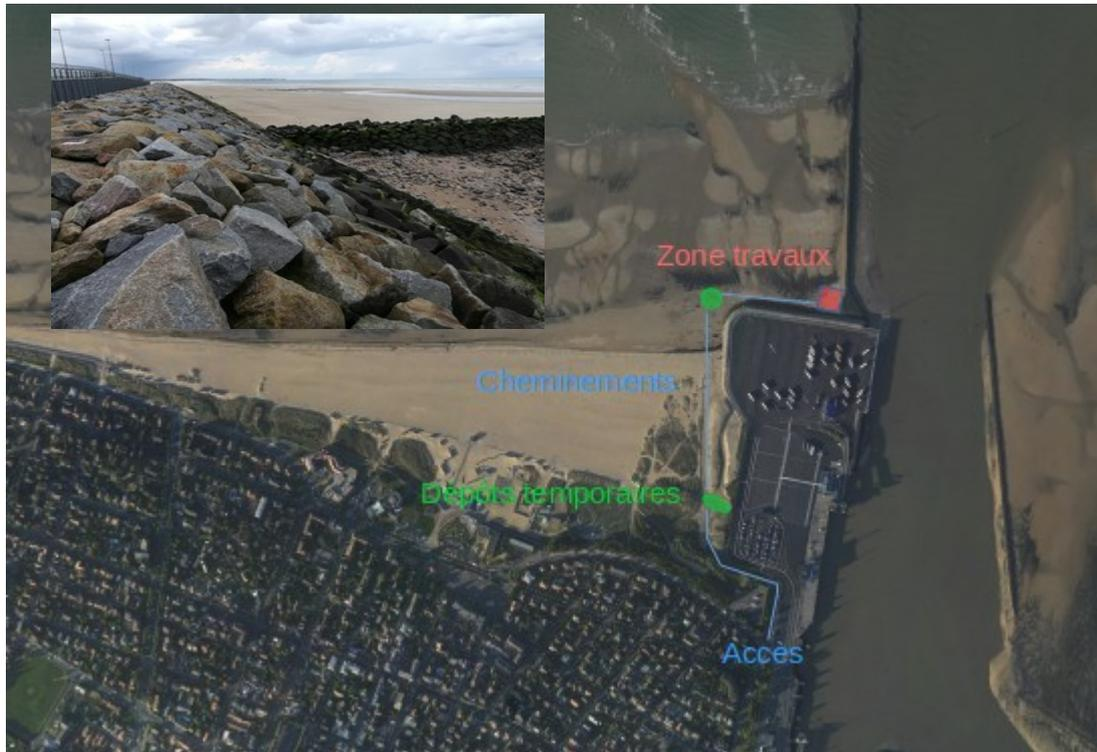
Photo 2 : Vue aérienne des zones d'accès, de dépôts et de travaux près de l'épi (encart)
